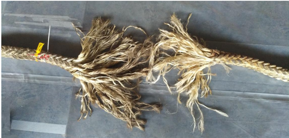
Εικόνα 1: Τα δύο τεμάχια του κάβου πρόσδεσης που προέκυψαν από τη θραύση του.
